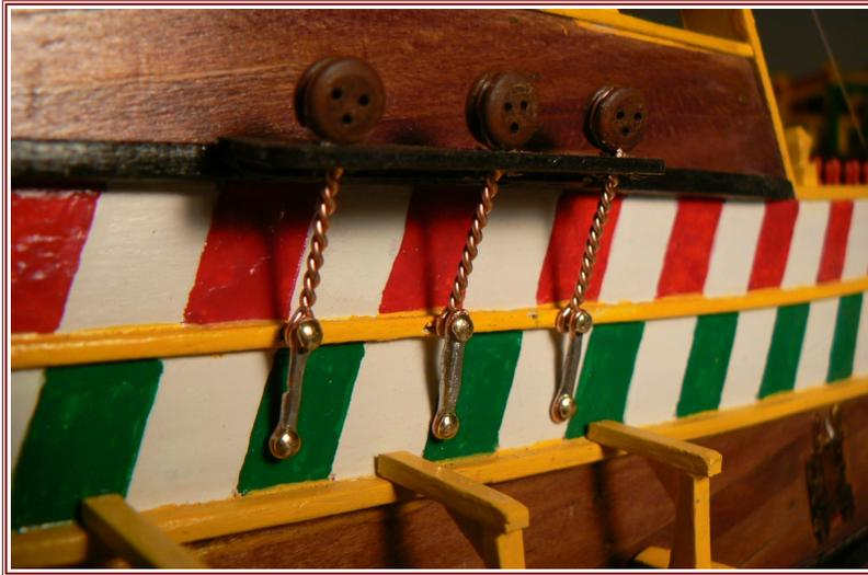
Les cadènes sont posées sur la muraille dès la présentation des ébauches des mâts en tenant compte de l'amure des haubans sur le mât et des sabords de la muraille
