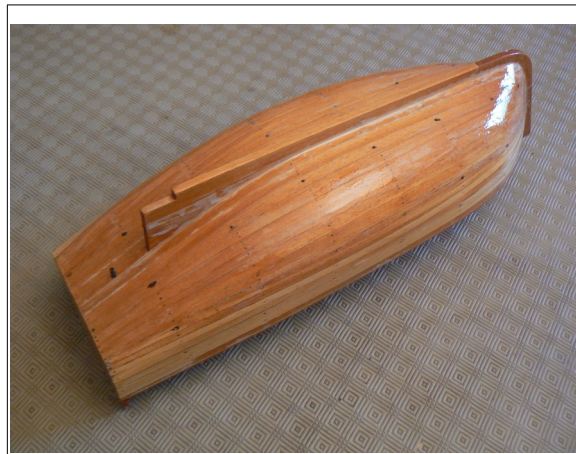
La coque finie et enduite de résine Époxy
