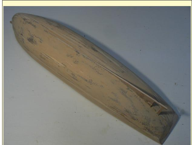
*Après ponçage des 1ères couches : enduit fin et ponçage final*
